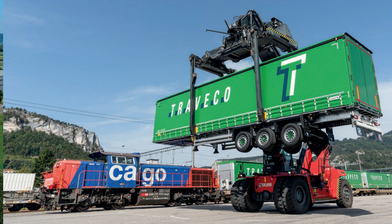
Ökologisch unterwegs: Trailer-Umschlag im intermodalen Verkehr
